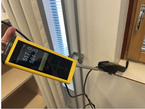
Kuva 86. Merkkiainekaasun havaittiin kulkeutuvan sisäilmaan ulkoseinäliittymien kautta.
