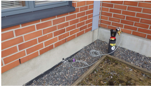
Kuva 86. Merkkiainekaasun havaittiin kulkeutuvan sisäilmaan ulkoseinäliittymien kautta.
