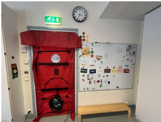
Kuva 80. Tilat aalipaineistettiin keinotekoisesti merkkiainekokeen ajaksi.
