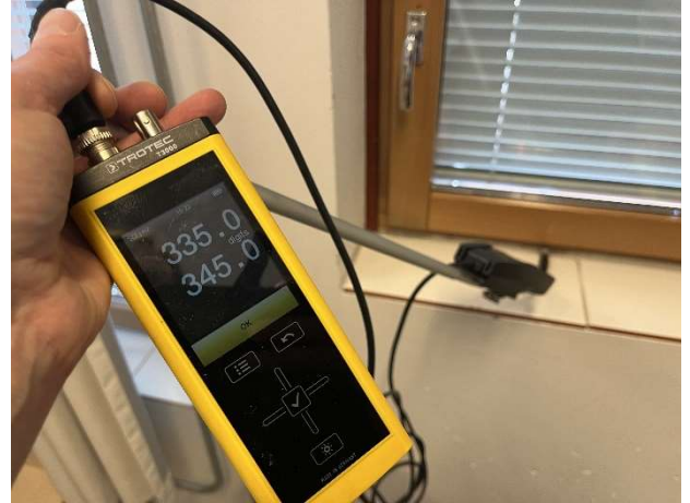
Kuva 87. Merkkiainekaasun havaittiin kulkeutuvan sisäilmaan ulkoseinäliittymien kautta
