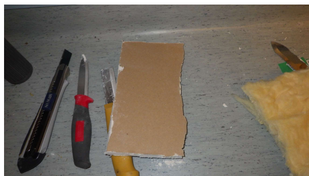
Kuva 60. VS2. Kipsilevyjen sisäpinnoilla ei havaittu poikkeavaa.
