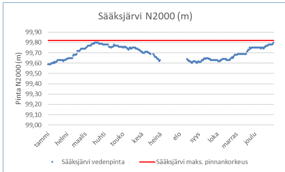
Kuva 7.1. Sääksjärven vedenkorkeus N2000-järjestelmässä vuonna 2020. Lisäveden juokutus Sääksjärveen on lopetettava, kun järven pinta saavuttaa tason N2000 +99,82. Pinnankorkeusmittari oli epäkunnossa 1.7.-12.8.2020, (tiedot: Nurmijärven Vesi).
