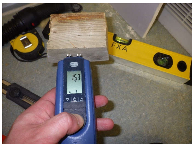
Kuva 42. Alaohjauspuun alapinnan ja alaohjauspuun ulkosyrjän kosteuspitoisuudeksi mitattiin 15 p-%.
