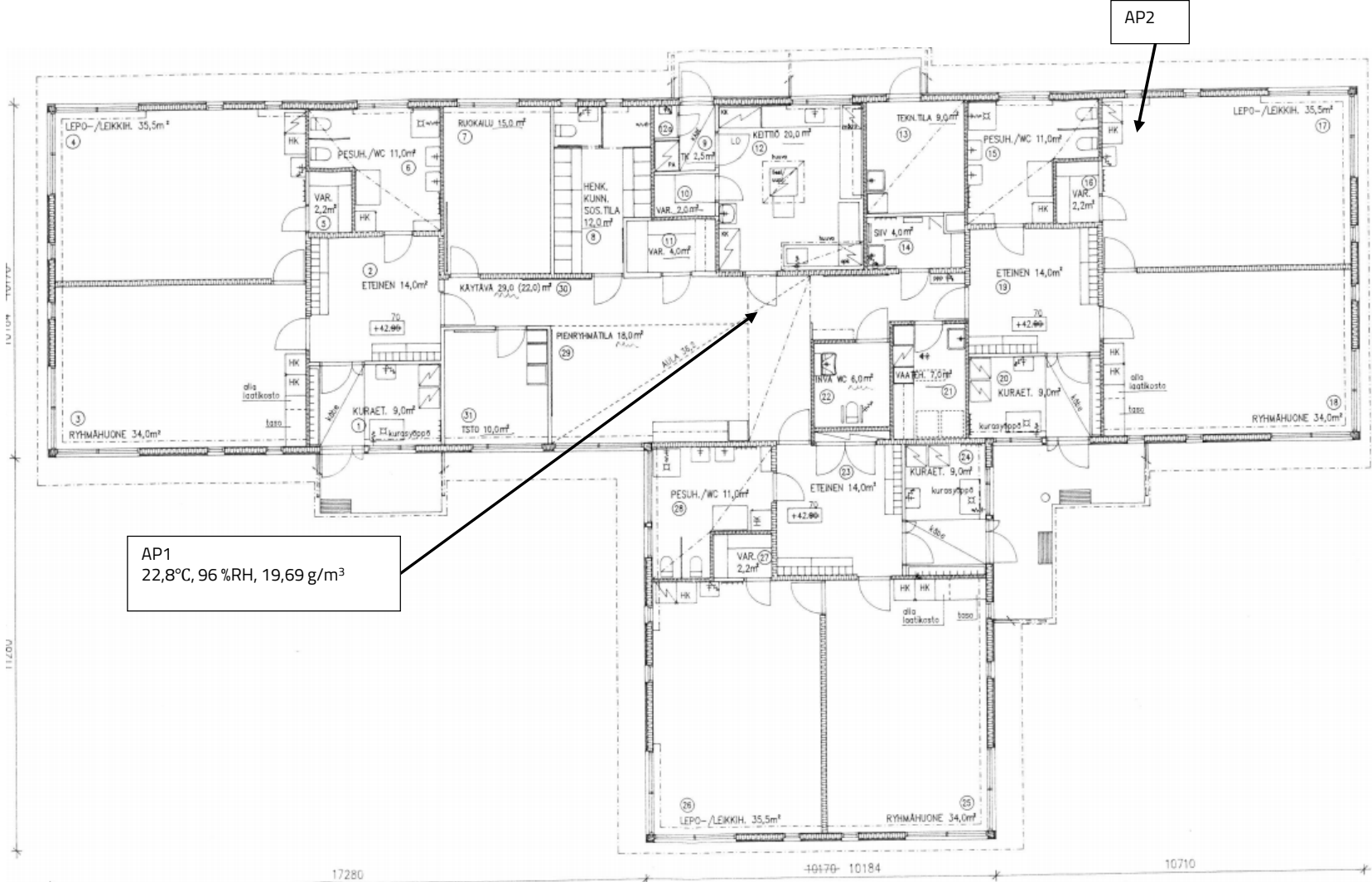
Liite 1. Alapohjan rakenneavaukset.
