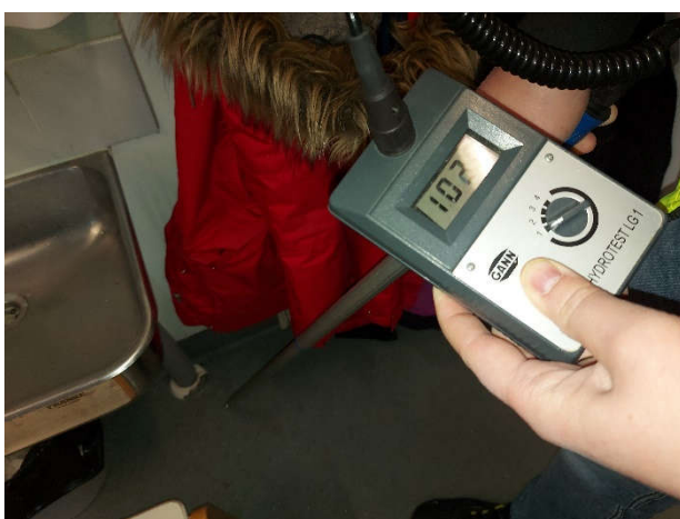
Kuva 22. Kivisten ryhmässä havaittiin poikkeavia pintakosteusarvoja kuraeteisen alueella.
