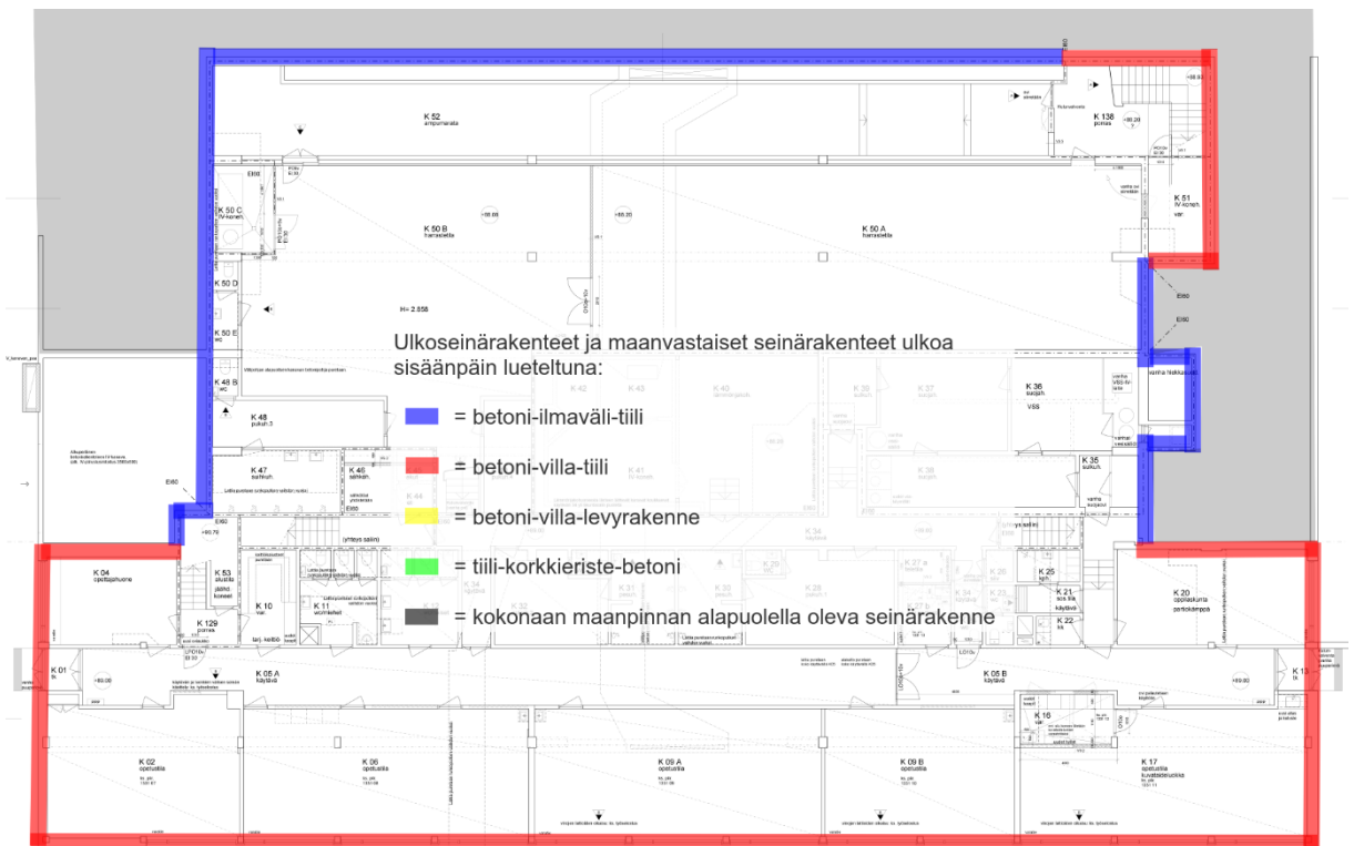
Kuva 48 Kellarikerros. Ulkoseinien ja maanvastaisten seinärakenteiden sijaintikaavio.
