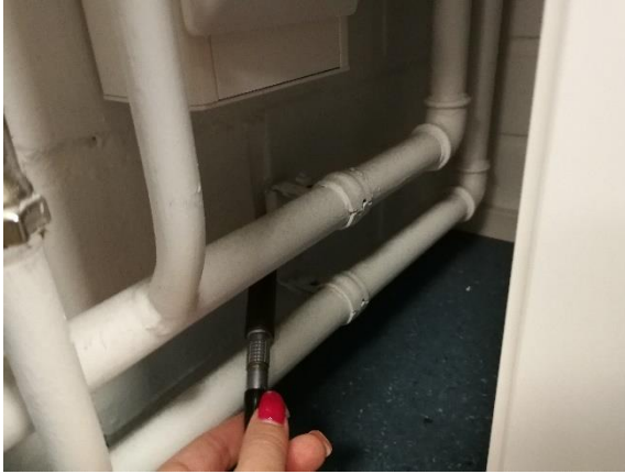
Kuva 28 Ilmavuotoa patterikannakkeiden läpivienneistä.
