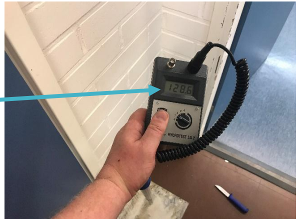
Kuva 40 Pintakosteushavainto, vrt. edellinen kuva.
