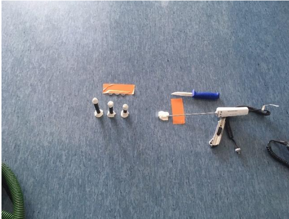
Kuva 43 Yleiskuva/esimerkki alapohjan viilto- ja rakennekosteusmittauspisteistä kotitalousluokassa.
