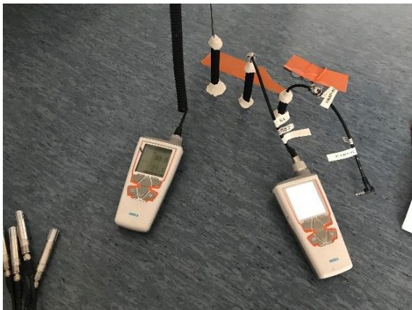
Kuva 41 Yleiskuva/esimerkki alapohjan rakennekosteus- mittauspisteistä kotitalousluokkatilasta.
