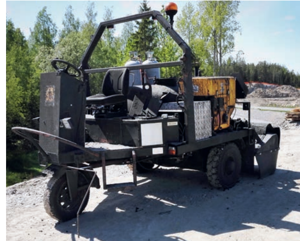
Metsäkylän risteyssillalla asfalttiryhmän liima-levitin, jolla levitetään bitumiemulsiota.
