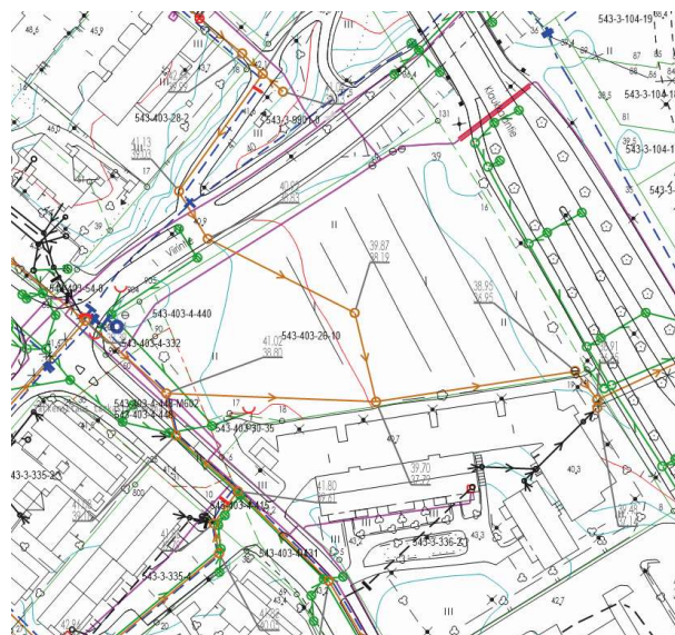
Kuva 13. Ote johtokartasta. Viemäri on esitetty ruskealla värillä, vesijohto sinisellä, hulevesiviemäri vihreällä ja kaukolämpö magentalla. Lisäksi aluetta sivuaa sähköjohto Ioseppälän varreissa. Alueen läheisyyteen, Viirintielle, on jo sijoitettu muuntamo vastaamaan alueen rakennusten sähkötarpeeseen.
