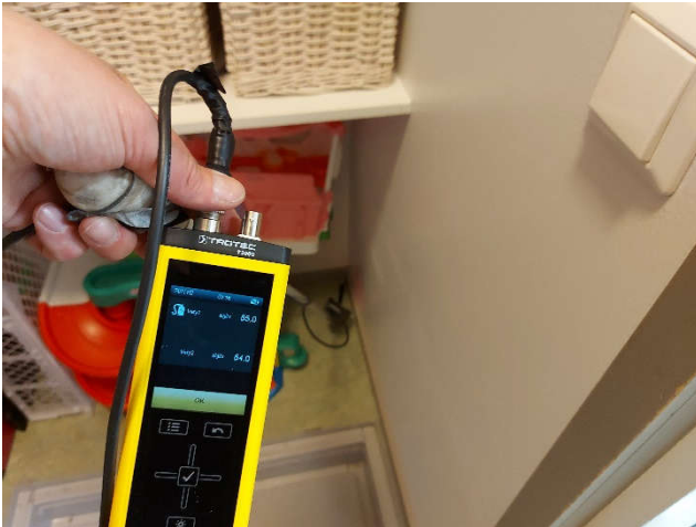
Kuva 15. Tilassa Ahmat merkkiainekaasu kulkeutui alapohjasta sisätiloihin kevyen väliseinärakenteen molemmin puolin, mahdollisesti ontelolaatan saumakohdasta.
