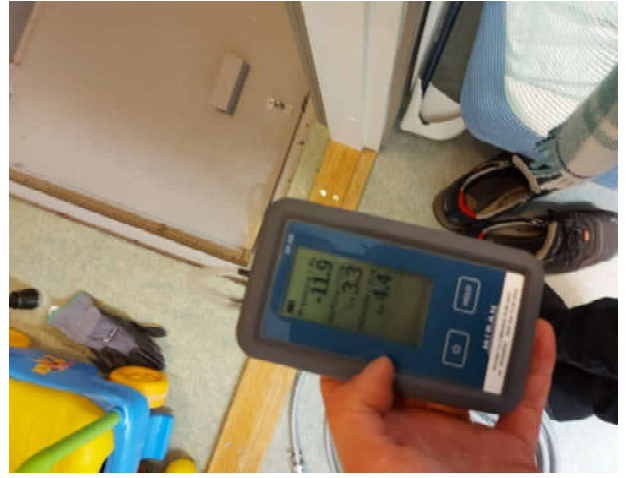
Kuva 2. Tutkimusten aikana paine-ero alapohjaan nähden oli noin 10-12 Pa alipaineinen.
