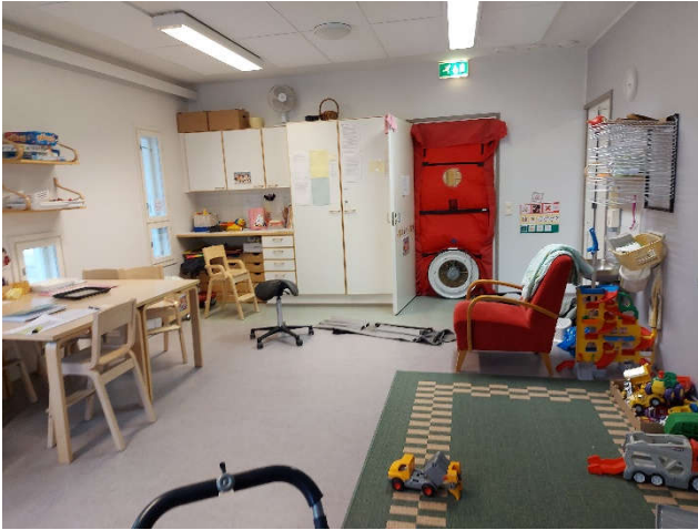
Kuva 1. Tutkittavat tilat alipaineistettiin keinotekoisesti merkkiainekokeen ajaksi.
