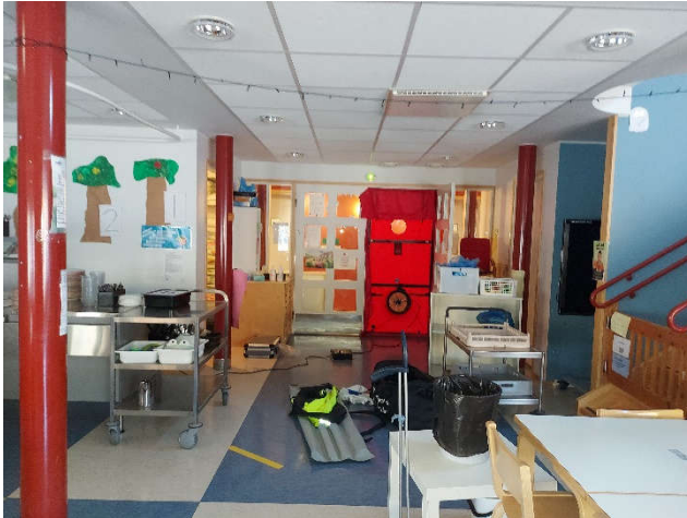
Kuva 1. Tutkittavat tilat alipaineistettiin keinotekoisesti merkkiainekokeen ajaksi.
