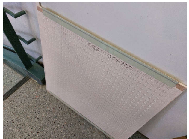
Kuva 66. Kipsilevyn yläpinnassa on harsokangas.
