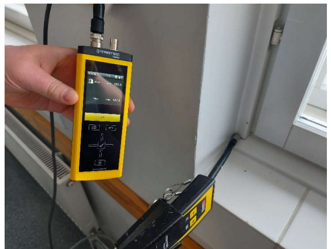
Kuva 99. Ilmavuotoa ikkuna-ulkoseinäliittymän kautta.
