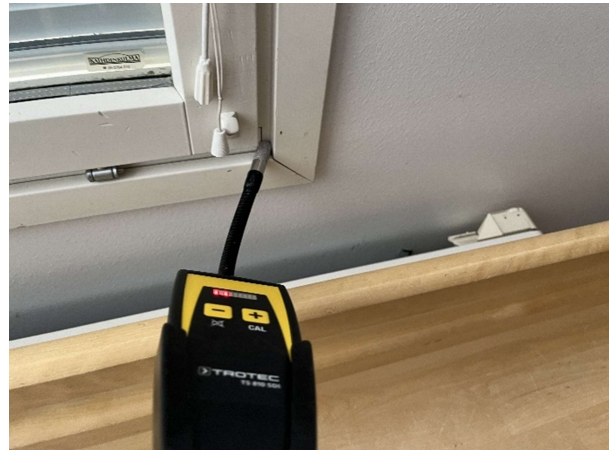
Kuva 89. Merkkiaineakaasun havaittiin kulkeutuvan sisäilmaan ulkoseinäliittymien kautta.
