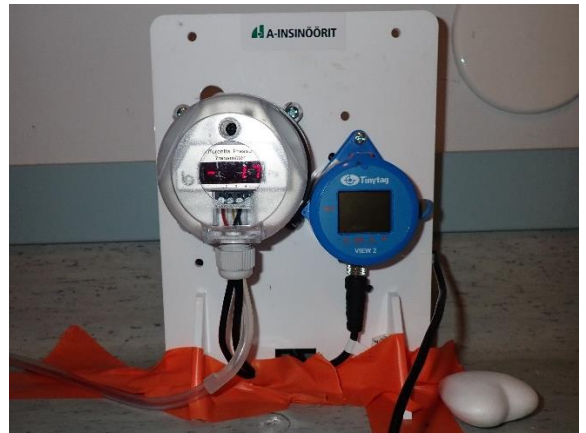
Kuva 31 Ennen tutkimuksen aloitusta käyntiluukun ollessa tiiviisti teipattuna huonetila oli noin -17 Pa alipaineinen ryömintätilaan verraten.
