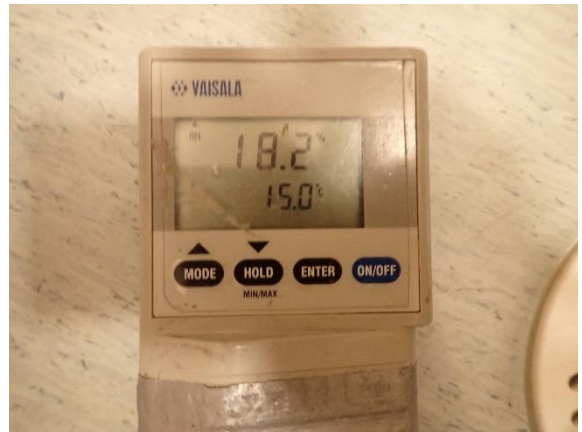
Kuva 47 Mitattu lämpötila suihkutilassa 043 tutkimuksen aikana oli 15°C. Termostaatin säätöasento oli 5-täysin auki.
