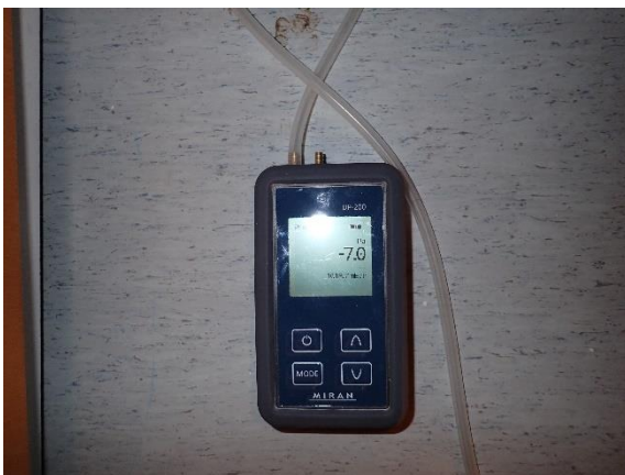
Kuva 32 Merkkiainekoe suoritettiin sisätilojen ollessa noin -7 - 10 Pascalia alipaineiset ryömintätilaan nähden.
