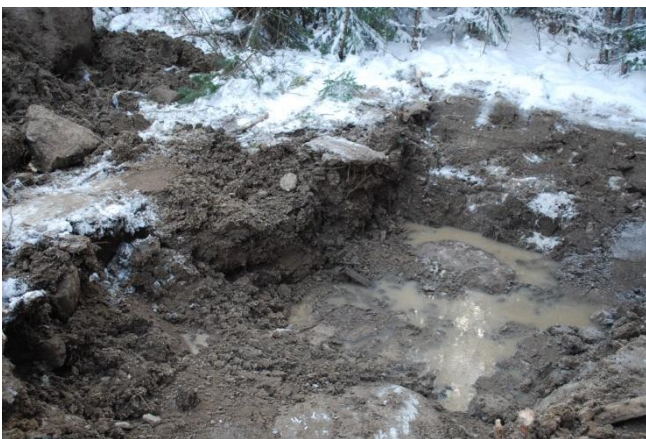
Kuva 5. KK2. Koekuoppaan noruu vettä 0,7 metrin syvyydeltä.
