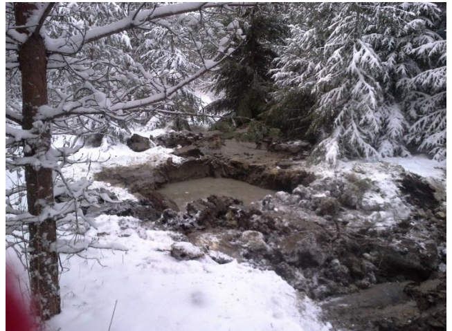
Kuva 4. KK1. Koekuoppa täyttyi nopeasti vedestä kaivun saavuttaessa 0,5 metrin syvyyden.
