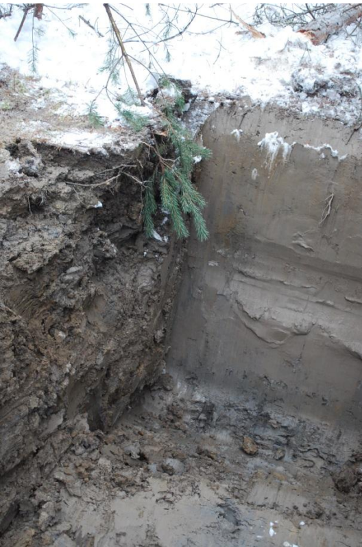
Kuva 9. KK3. Koekuoppa kaivettu 2,0 metrin syvyydelle
