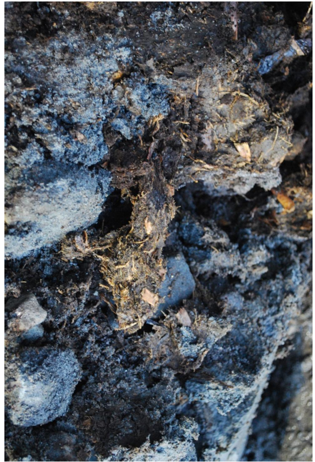
Kuva 16. KK4. Turvetta 5,5-6,0 metrin syvyydellä.
