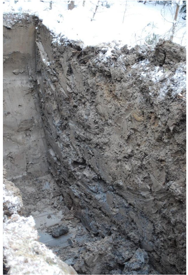
Kuva 12. KK3. Epähomogeenista täyttömaata 0-6,0 m.
