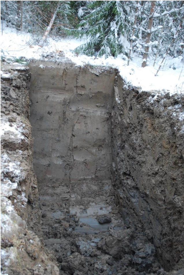
Kuva 11. KK3. Kuuden metrin syvyydessä täyttömaakerrokset jatkuvat edelleen.
