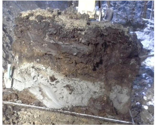
Kuva 24. KK6. Perusmaan pinta saavutettiin 4,8 metrin syvyydellä.
