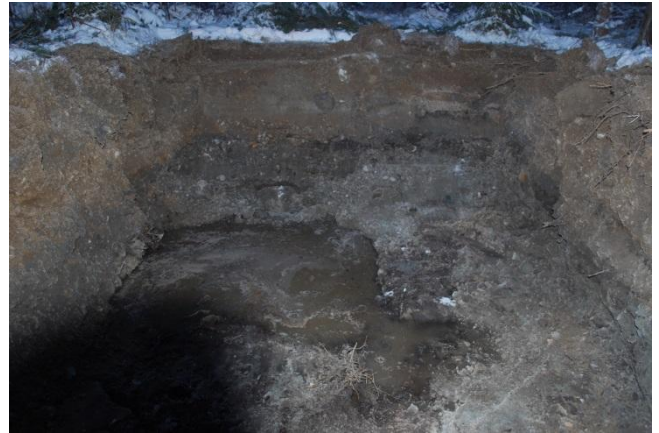
Kuva 20. KK5. syvyydeltä kuoppaan tulvii vettä.
