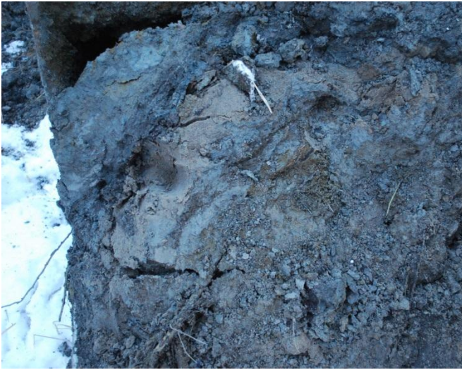
Kuva 23. KK6. Epähomogeenisia täyttömaakerroksia.
