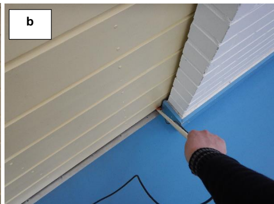
Kuvat 15a ja b. Itäseinällä, ensimmäisen pilarin juuresta, havaittiin voimakasta ilmavuotoa (kuva a). Voimakasta ilmavuotoa havaittiin myös oviaukon oikeasta reunasta, väliseinän juuresta (kuva b).
