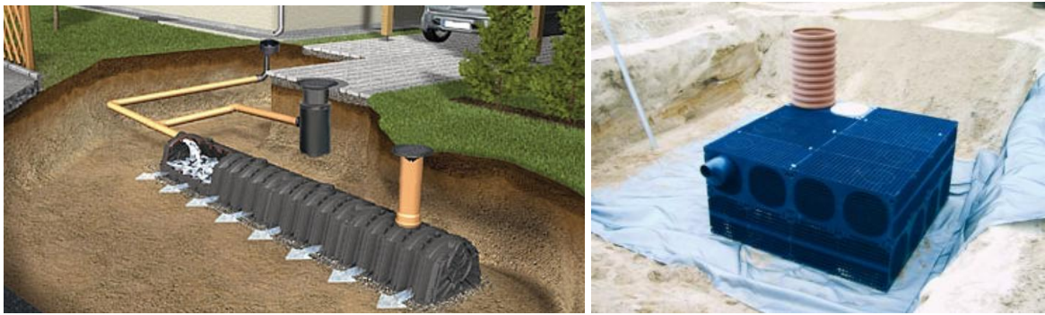
Kuvat 15 ja 16. Hulevesitunneli hulevesien imeyttämistä varten (Uponor Oyj) ja hulevesikasettipesä hu- levesien viivyttämistä tai imeyttämistä varten (Wavin-Labko Oy)
